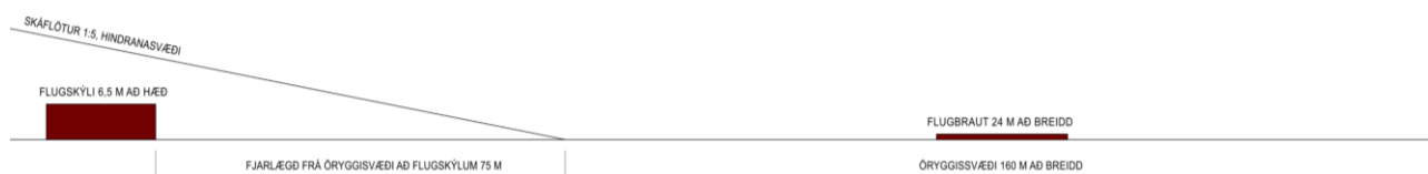
Mynd 3. Snið sem sýnir 160 m öryggissvæði og skáflöt í 1:5 sem hindranasvæði flugvallarins.
